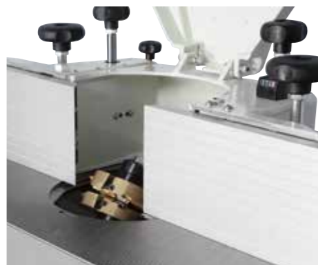
Tilting spindle 90 ÷ 45°. Schwenkbare Spindel 90 ÷ 45°.
