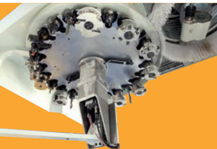
Magazzino rotativo posteriore a 24 postazioni 24-position rear rotary tool changer Almacén rotativo posterior a 24 posiciones
