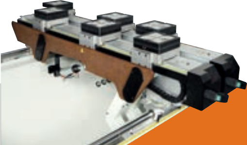
Panel lifting unit Anhebeschiene Soulèvement panneaux
