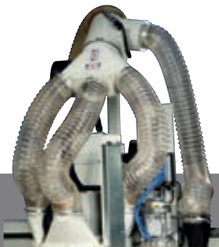
Partialized dust extraction collector Unterteilter Absaugungsförderer Convoyeur d'aspiration partagé
