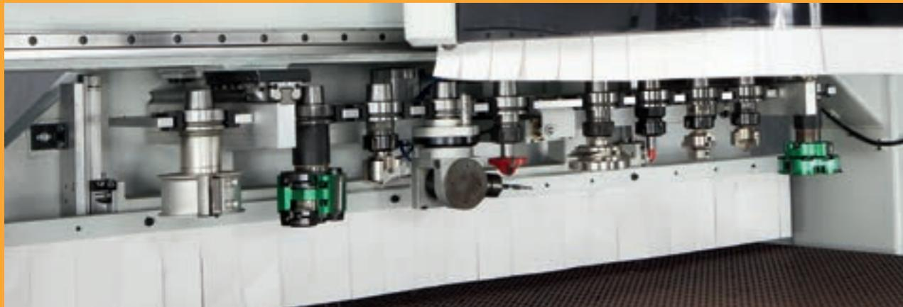
Con il magazzino sotto-trave ST10 il tempo di attrezzaggio è estremamente ridotto
