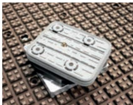
Ventose orientabili modulari - Swivelling modular cups - Ventosas orientable modulares
