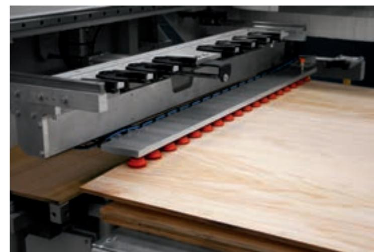
Flessibilità: dispositivo sotto trave per il caricamento automatico del pannello (versione B).
