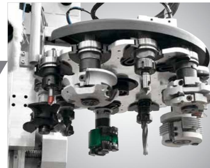
RP16/24: hinteres Werkzeuglager mit 16/24 Positionen, drehbar
