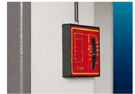
Blade tension indicator (only for C.E. version) Indicateur tension lame (seulement pour version C.E.)
