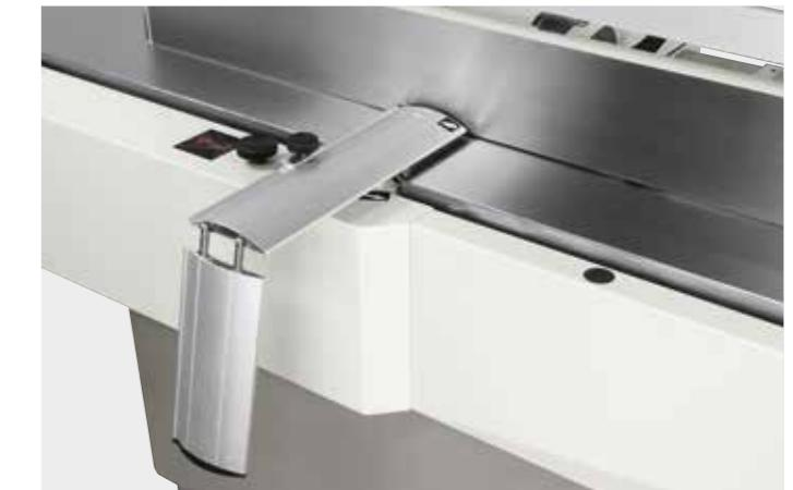
La protezione è ripiegabile in funzione delle esigenze di lavorazione. Questo sistema è stato studiato in modo da offrire una protezione efficace per l'operatore.
