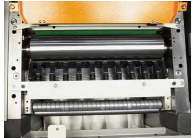
Gruppo pialla con martelletti anti-ritorno e pressatori in entrata sezionati, rullo di traino in acciaio con dentatura elicoidale in ingresso ed un rullo di traino ricoperto in gomma in uscita. I rulli sono facilmente intercambiabili.
