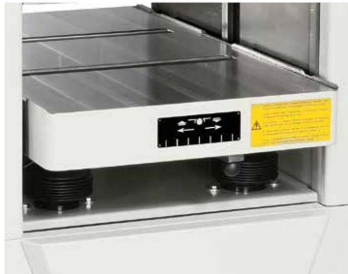
Per facilitare l'avanzamento di pezzi di grossa sezione è disponibile, a richiesta, il piano spessore con 2 rulli folli flottanti registrabili in altezza.
