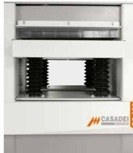
Sollevamento motorizzato del piano spessore a 2 velocità, con regolazione micrometrica e mediante 4 viti in acciaio protette da soffietti anti-polvere.
