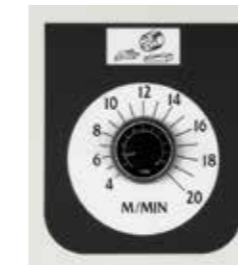
PS 630 Regolazione continua della velocità allo spessore tramite inverter da 4 a 20 m/min.
