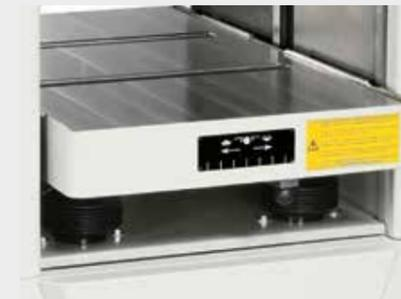
To facilitate feed of large section stock it is available, on request, the worktable with 2 idle floating bed roller with height adjustment. Pour faciliter l'entraînement de pièces de grosse section il est disponible, sur demande, le table rabot avec 2 rouleaux flottants libres et enregistrables en hauteur.
