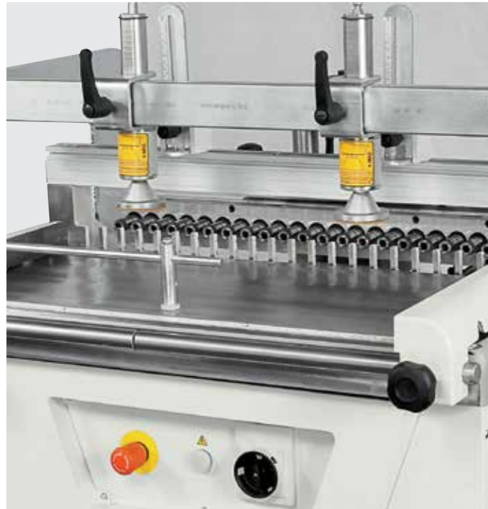
Lateral fence L=3000 mm, used for multiple linear boring. Guide latéral L=3000 mm, utilisé pour perçages multiples en ligne.
