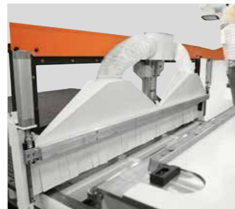
Unloading device with integrated suction system (optional) Dispositif de déchargement avec système d'aspiration intégrée (option) Abladevorrichtung mit integrierter Absaugung (Sonderzubehör)
