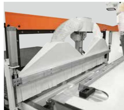
Dispositivo di scarico con aspirazione integrata (opzionale).
