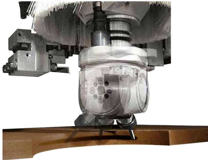
Dispositivo 0 ÷ 360°: flessibilità senza limiti. Dispositivo a controllo digitale gestito da CN per il posizionamento a 360° delle testine a rinvio angolare (opzionale).
