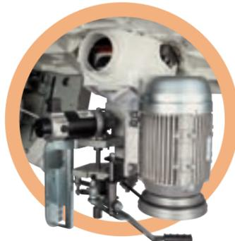
Spindle moulder with 4 spindle rotation speeds as standard. Speed change is by means of a 4-groove pulley system. This system maintains unchanged the motor power available on the spindle even during use of lower speeds. Groupe toupie à 4 vitesses de rotation de l'arbre toupie livrées standard. Le changement de vitesse se fait par un système de poulies à 4 gorges. Ce système maintient la puissance du moteur disponible sur l'arbre inchangée même pendant l'utilisation aux vitesses plus basses.
