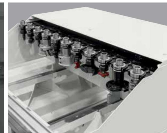
ST 14 PLUS: magazzino interno alla struttura protettiva che garantisce la massima produttività ed un veloce set-up.
