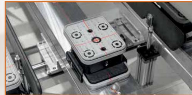
Posizionamento perfetto con il dispositivo laser per ventose.
