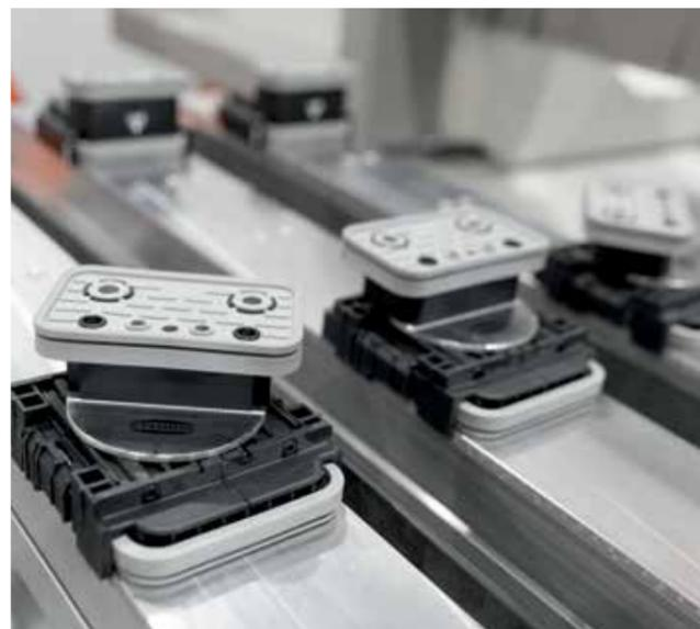
Piani di lavoro "TL": stabilità e flessibilità. Facilità di attrezzaggio e stabilità del pezzo in lavorazione garantiscono un prodotto finito di alta qualità.
