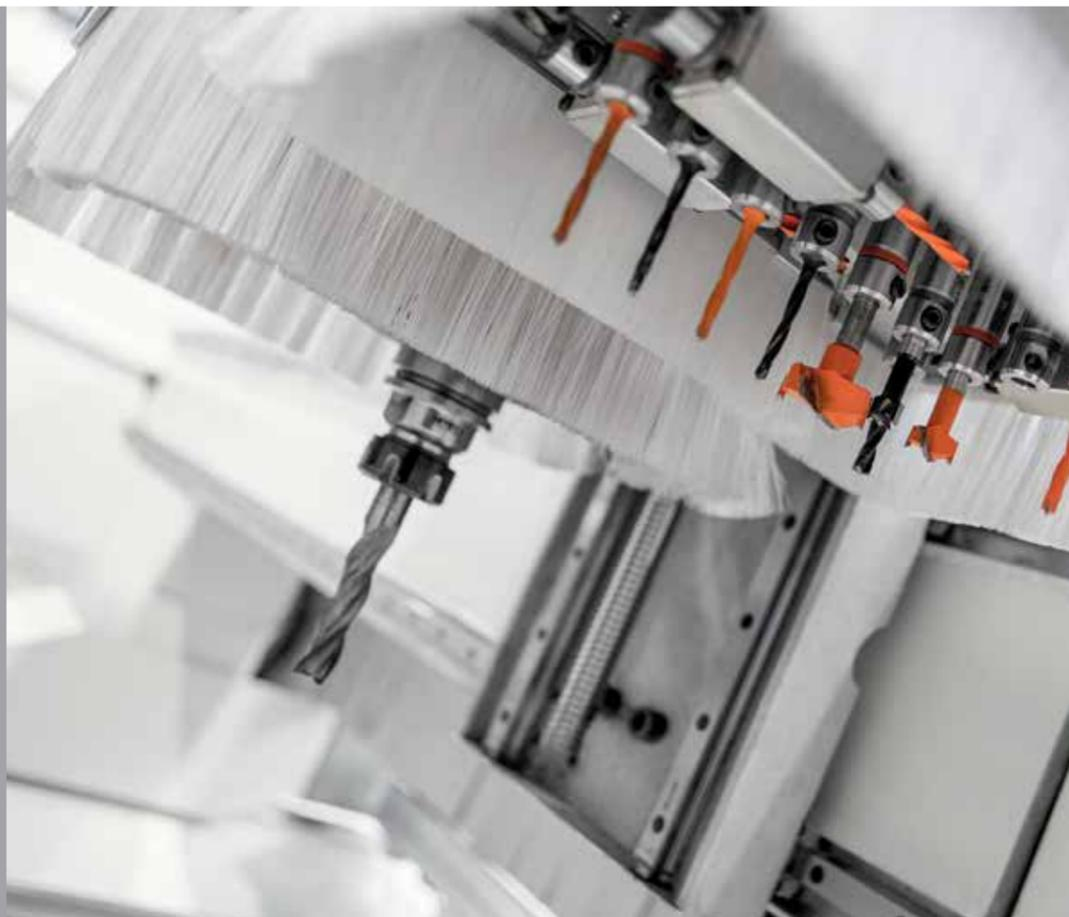
Rapido set up con i magazzini utensili LINEAR 11 e ST14 Plus. Possibilità di carico di 25 utensili.
