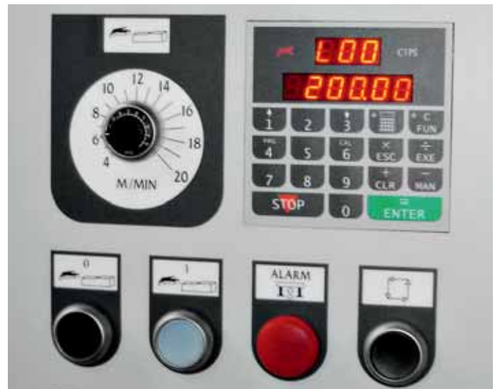
The thickener table electronic positioner, available on request, enables fast and precise worktable positionings. With calculator included. Le positionneur électronique de la table de rabotage, disponible sur demande, permet des positionnements de la table de rabotage rapides et précis. Fonction calculatrice comprise.
