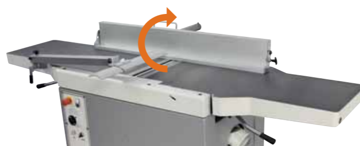
Auxiliary flip-over fence for thin parts, available on request. Schwenkbarer Hilfsanschlag für dünne Werkstücke auf Anfrage.
