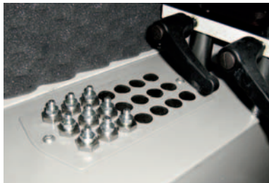
Centralized lubrication of the fences. Graissage centralisée des guides.
