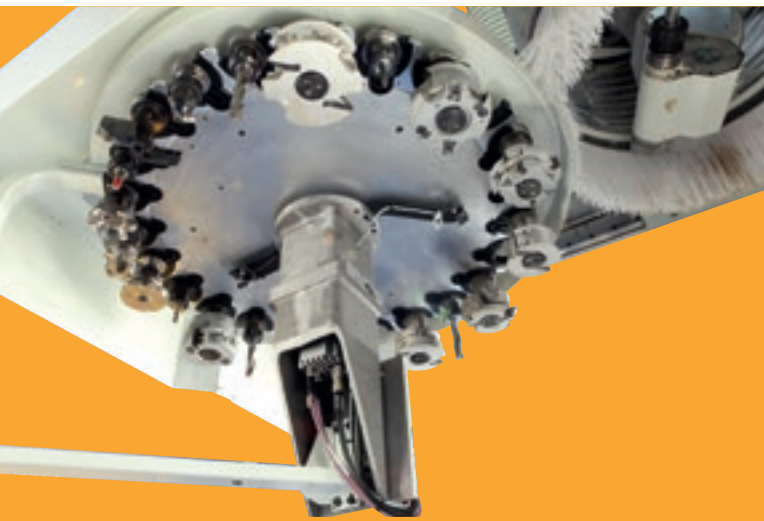
24-position rear rotary tool changer Hinteres Werkzeuglager mit 24 Positionen Magasin rotatif arrière à 24 positions
