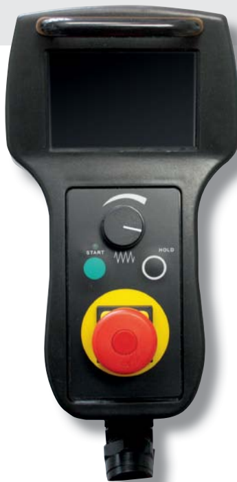
Remote push-button panel Handbedienelement mit Potentiometer und Notaus Pupitre de commande à distance
