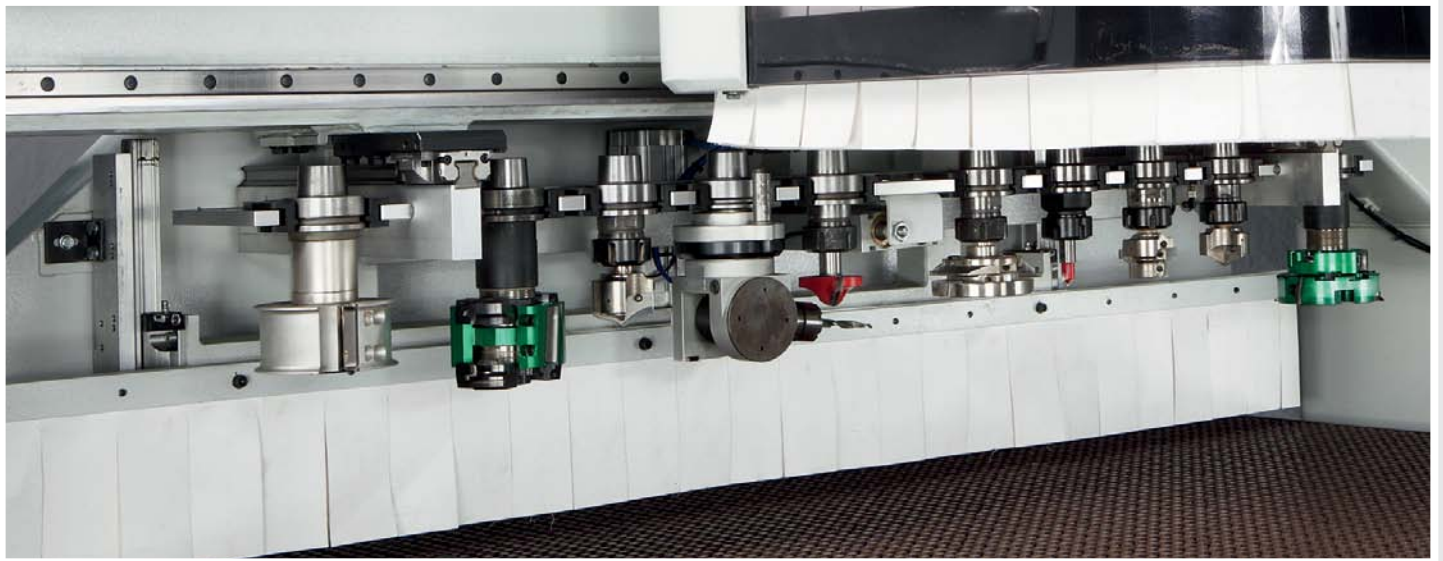
ST 10 tool changer ST 10 Werkzeugmagazin Magasins outil ST 10
