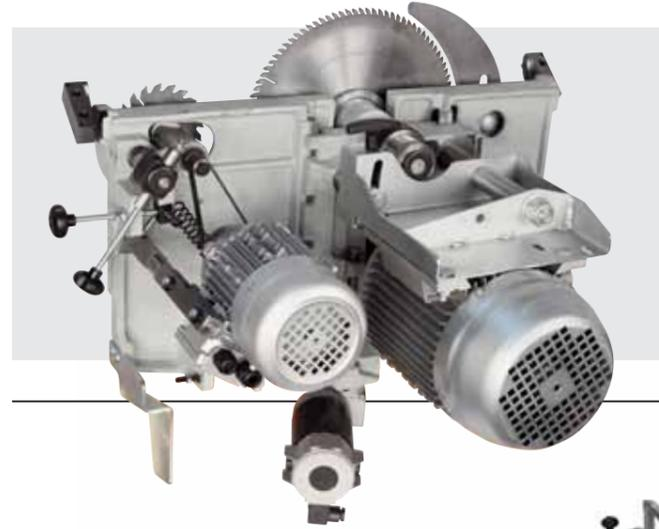
Heavy duty cast iron saw unit with vertical raise & fall of the main blade over a precise dove-tail system, tilting system over two heavy hardened steel trunnions. Powered raise & fall of the main blade available on request. Groupe lame en fonte avec système de montée/baisse verticale de la lame principale sur guides en queue d'aronde, système d'inclinaison sur deux lunettes en acier. Le système de montée/baisse motorisé de la lame principale est disponible sur demande.
