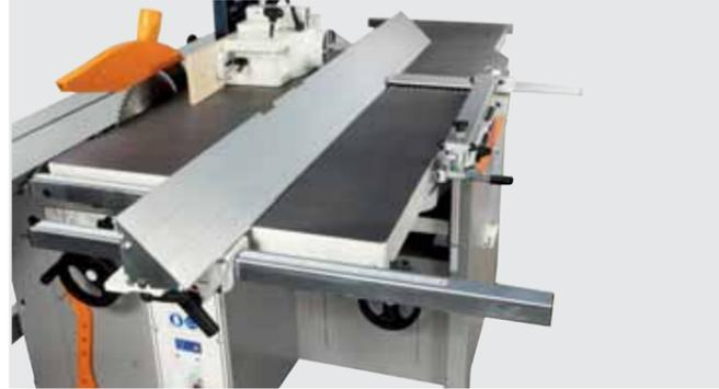
Thick ribbed cast iron worktables. The tables are carefully machined by numerical control machines to guarantee maximum machining precision. Les tables d'usinage sont en fonte nervurée de grande épaisseur. Les tables sont usinées soigneusement par machines à contrôle numérique pour garantir une précision maximum des usinages.
