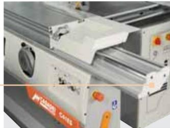
Hardened steel guideways with double prismatic guideway, preloaded ball bearings and hardened sliding ways. Precision, smooth running and absence of maintenance are unique features of the CASADEI sliding table. Chariot à guides prismatiques en acier trempé à interposition de billes et guides trempés fixés par sertissage. Précision, coulissement fluide et absence d'entretien sont les caractéristiques exclusives des chariots CASADEI.
