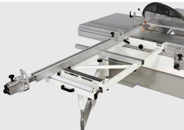
Guida per tagli in squadro con visualizzatore elettronico digitale su ogni battuta (3) e sistema di lettura della posizione delle battute su banda magnetica. Disponibile su richiesta.
