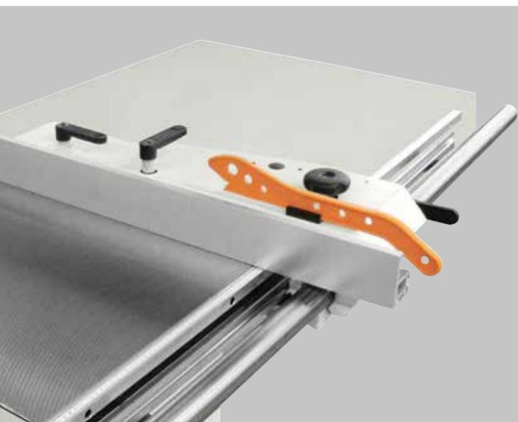
Guida per tagli paralleli molto robusta con regolazione micrometrica tramite cremagliera, e bloccaggio rapido tramite eccentrico. La guida scorre su una barra rotonda in acciaio rettificato ed è ribaltabile. La guida può essere ruotata di 90° per tagliare pezzi sottili.
