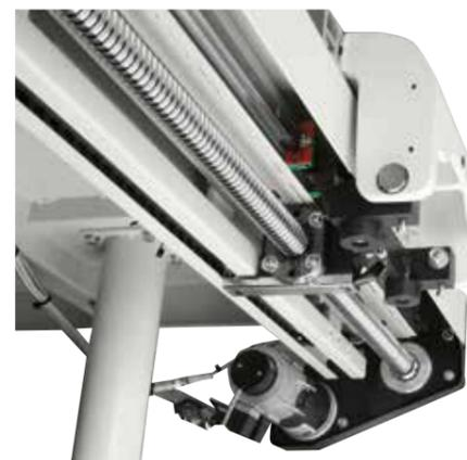
Guida parallela con posizionamento a controllo numerico. Disponibile su richiesta. La guida parallela è posizionata da una vite a ricircolo di sfere e scorre su una guida prismatica THK. La guida può essere ruotata di 90° per tagliare pezzi sottili ed è totalmente escludibile sotto il piano. Sistema di sicurezza anti-colliisione.
